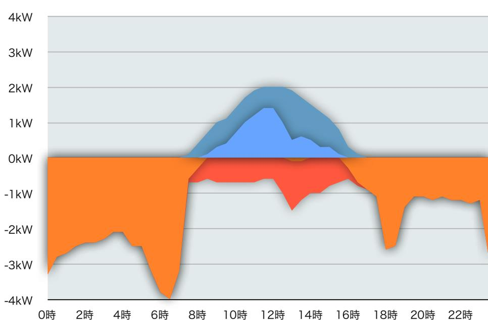
■ 売電電力 ■ 発電電力 ■ 買電電力 ■ 消費電力
