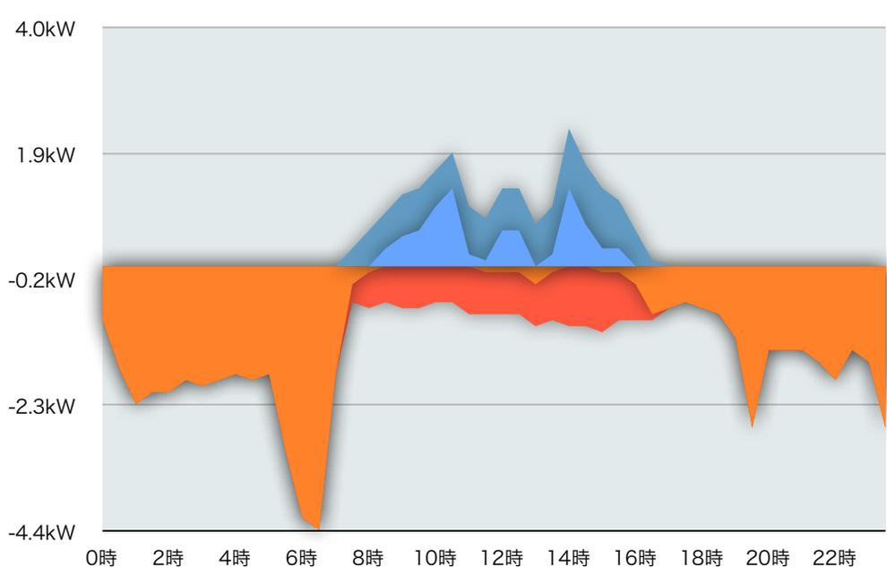
■ 売電電力 ■ 発電電力 ■ 買電電力 ■ 消費電力
